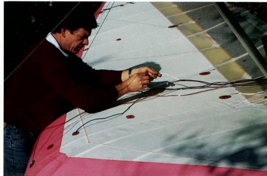
Dipl.-Ing. Axel Schneider befestigt die Drucksonden an der Segeloberfläche
